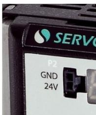
图 3-20. 24V 逻辑电源输入接口
