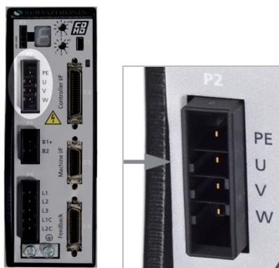
图 3-14. 电机相线接口(此图型号: 中压型 CDHD-006)
